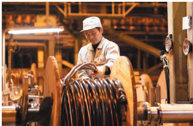
電線の切分け作業
